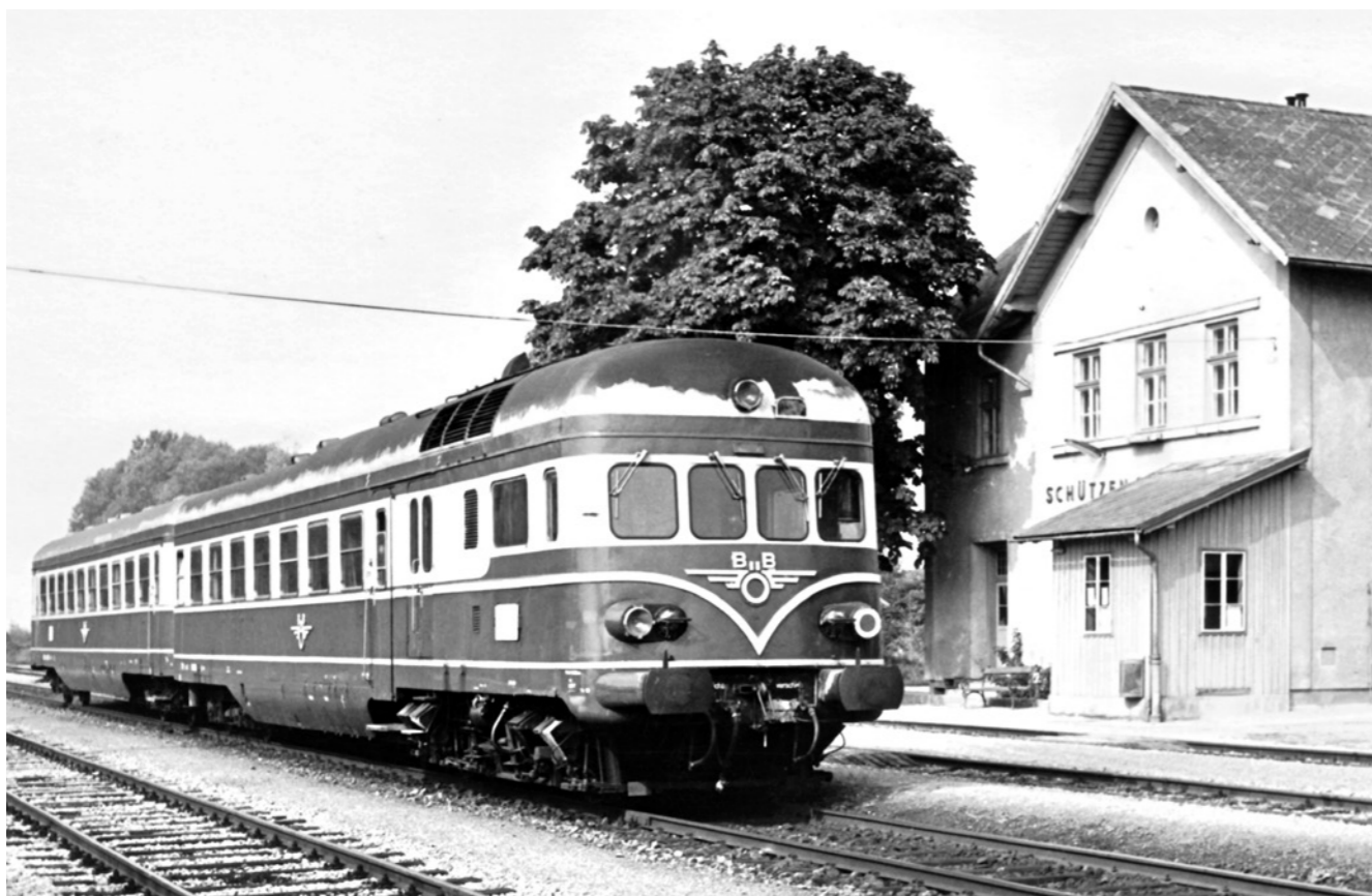
Lange Zeit prägten die Dieseltriebwagen der Reihe 5145 das tägliche Bild auf dieser nordburgenländischen Nebenbahn. Beachtenswert sind die Erdbahnsteige, der hölzerne Vorbau, in dem das Stellwerk untergebracht war und der große Baum neben dem Bahnhofsgebäude. Ein 5145 steht am 9. September 1979 im Bahnhof Schützen am Gebirge und wartet auf die Weiterfahrt nach Eisenstadt. (Foto Ernst Kabelka)
